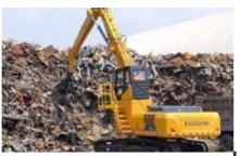
**ENGINE:** Cummins RATED POWER: 226 hp @ 2050 rpm **BASE OP WEIGHT:** 43,500 kg **REACH:** 15 m
