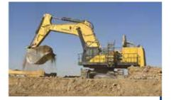
**ENGINE:** Cummins **NET POWER:** 760 hp @ 1,800 RPM **BASE OP WEIGHT:** 122,000 kg
